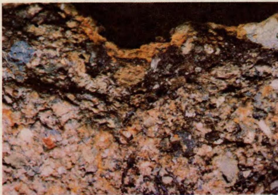
Figura 5b. Microfotografía óptica del cemento sílico-alumínico que une los clastos del horizonte 2Cg (65-86 cm) del "ñadi" Alerce. Las arenas son angulosas, frescas y de composición heterogénea (10 x 3,5; reflexión).
