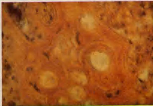
Fig. 10. Detalle de un vídrio palagonitizado (SD2 40-50). Microscopia óptica, luz natural.
