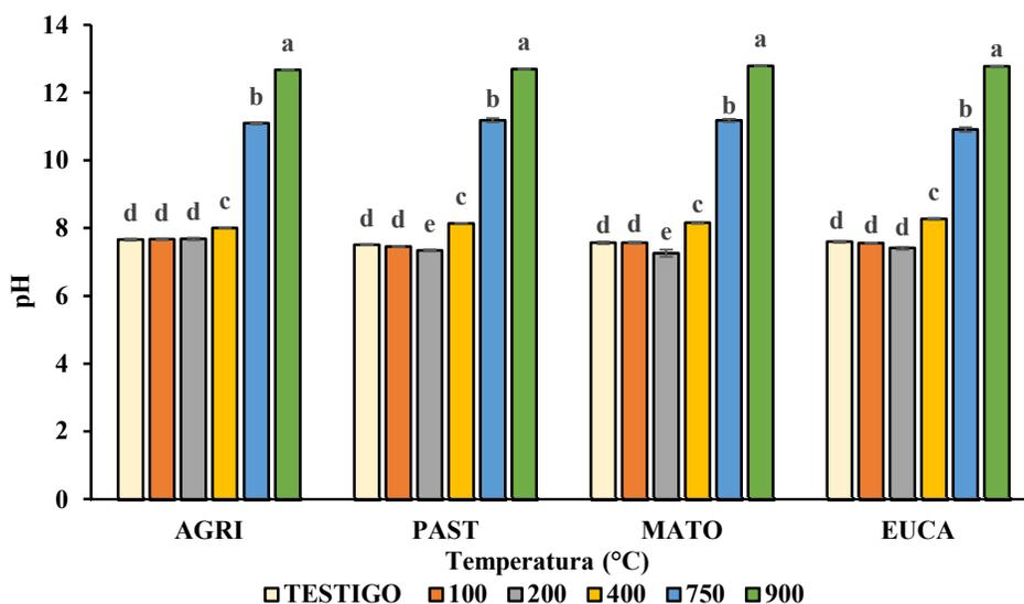
**Figura 3. Prueba pareada de pH con el análisis de Mann-Whitney U ( $P \leq 0.05$ ) entre las temperaturas para cada uso de suelo.** AGRI = suelo de uso agrícola; PAST = suelo con pastizal; MATO = suelo con vegetación de matorral; EUCA = plantación de eucalipto. Letras distintas indican que existe diferencia significativa entre la hidrofobicidad para cada uso de suelo.
