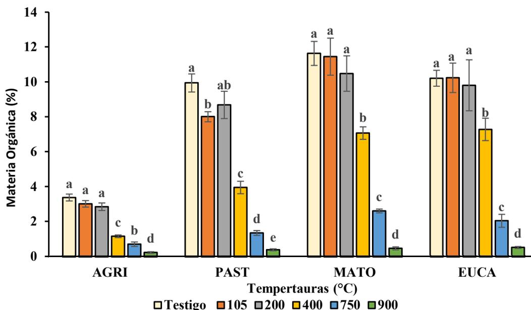
**Figura 4. Prueba pareada de MO con el análisis de Mann-Whitney U ( $P \leq 0.05$ ) entre las temperaturas para cada uso de suelo.** AGRI = suelo de uso agrícola; PAST = suelo con pastizal; MATO = suelo con vegetación de matorral; EUCA = plantación de eucalipto. Letras distintas indican que existe diferencia significativa entre la hidrofobicidad para cada uso de suelo.
