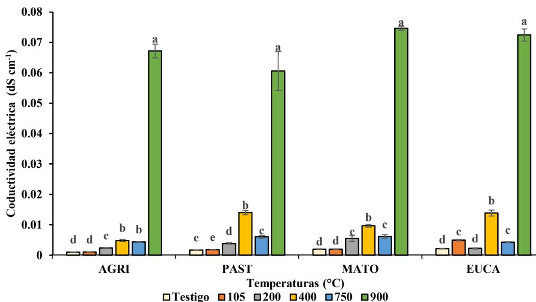
**Figura 5. Prueba pareada de CE con el análisis de Mann-Whitney U ( $P \leq 0.05$ ) entre las temperaturas para cada uso de suelo.** AGRI = suelo de uso agrícola; PAST = suelo con pastizal; MATO = suelo con vegetación de matorral; EUCA = plantación de eucalipto. Letras distintas indican que existe diferencia significativa entre la hidrofobicidad para cada uso de suelo.
